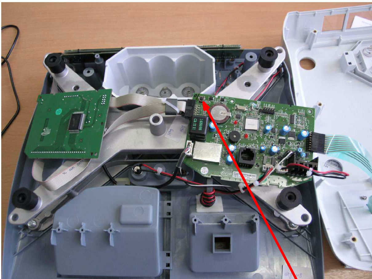
Pogled na matične ploče vage i tipkalo za pristup mjeriteljskim značajkama
