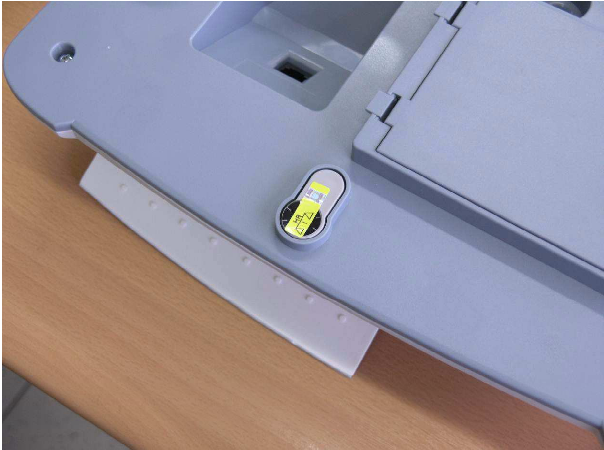
Način zaštite pristupa tipkalu na matičnoj ploči.
